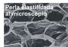
El efecto "muelle" de la elastificación favorece el comportamiento masa + muelle + masa, aportando así poder de aislamiento acústico.
